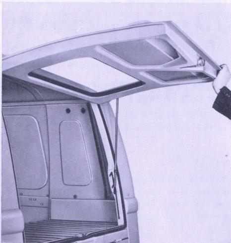
Zum Schließen heben Sie die Rückwandklappe etwas an und ziehen die Stütze aus ihrer Raste heraus.
