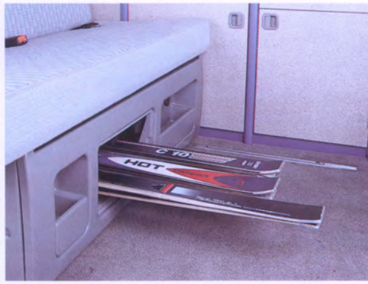
Durchladeräume für sperriges Gut
