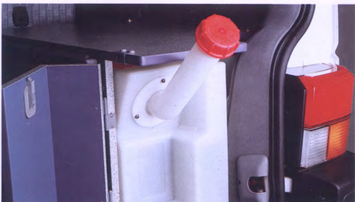
Gut zugänglicher Wassertank, ca. 50 l
